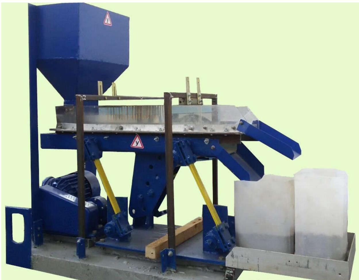
Рисунок 3 – Экспериментальная установка нового вибрационного грохота
