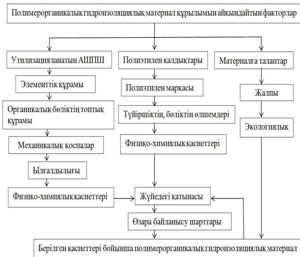
1 – сурет. Полимерорганикалық гидроизоляциялық материалдың құрылымдық құрамы
